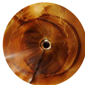
Mineralny olej hydrauliczny ISO VG 46: wynik po 1000 godzin (pierwsze objawy widoczne po 500 godzinach)
