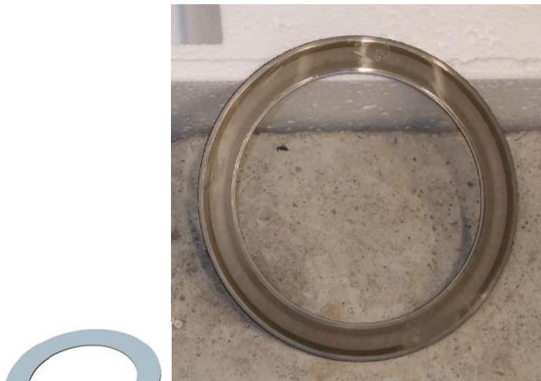
plytka robocza (zworu) stan dobry
