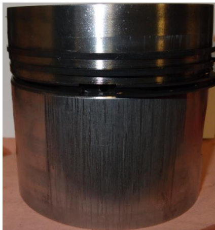
od strony nacisku tłoka na cylinder akceptowalny dostrzegalne rysy
